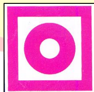
Pulsador de Alarma
